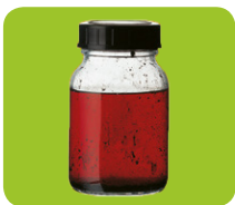
Standard-Heizöl im gealterten Zustand
