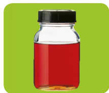
PremiumHeizöl ecotherm im gealterten Zustand
